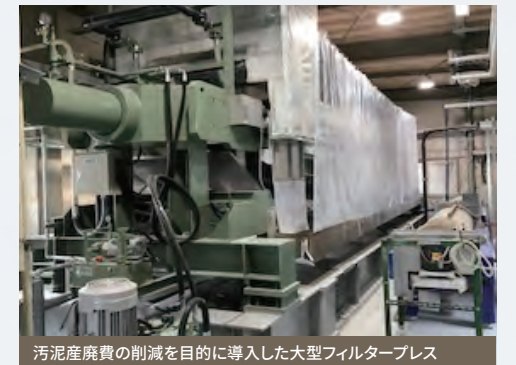
汚泥産廃費の削減を目的に導入した大型フィルタープレス
